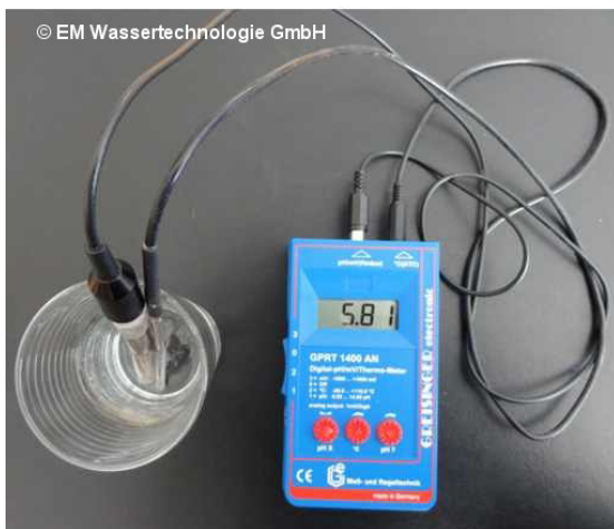
Bild: Umkehrosmosewasser: Der pH Wert von 5,81 zeigt einen zu „sauen“ Wert
