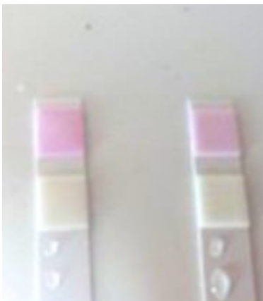
Teststreifen mit Nitratbelastung. Rechts vorher-links nach dem (unpassenden) Filtersystem: Das Nitrat-Problem besteht auch nach der Filterung weiterhin
