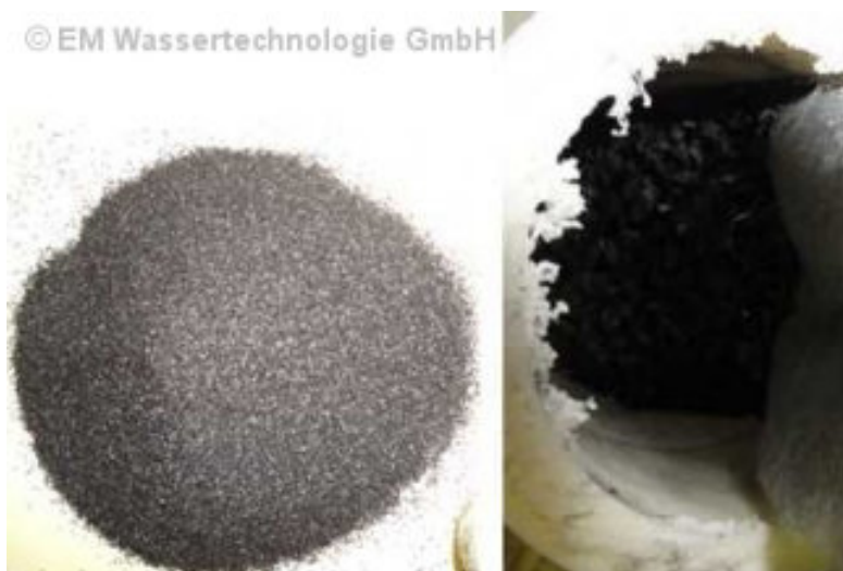
Bild: links – Aktivkohlegranulat, rechts – So sieht es in einem aufgeschnittenen Filter aus
